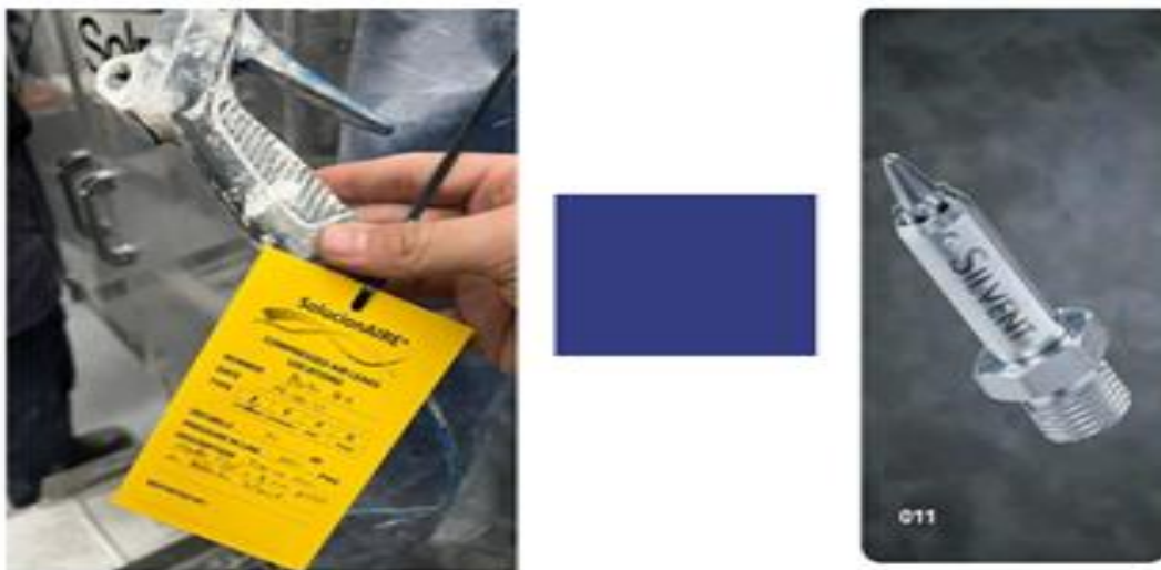
Figura 17. Pistola punto de soplado área de bodega.
