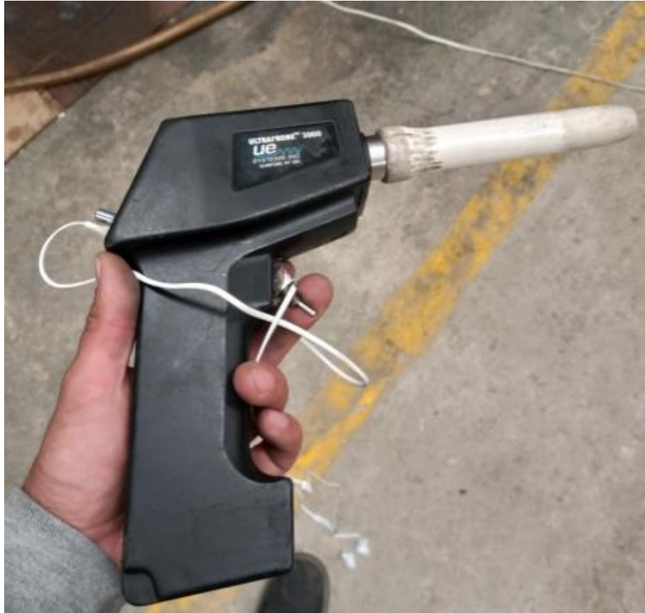
Figura 8. Pistola de ultrasonido 100-UP100-S. Fuente: autor.
