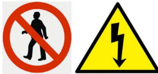
Figura 6. Símbolos que deben ir a la puerta de la subestación. Norma RA8-014.
