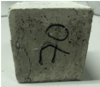
D. 70% de reemplazo de arena
