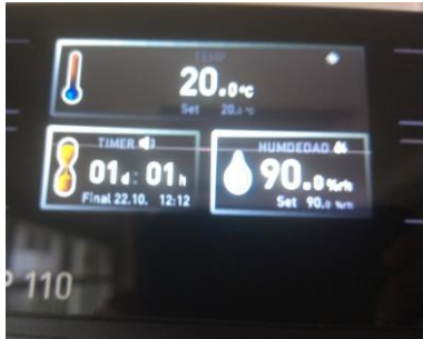
Imagen 20. Cámara de ambiente controlado caso de 20 °C y 90% de humedad
