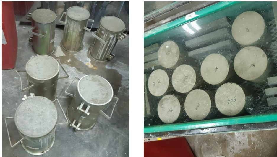
Imagen 10. Fabricación y curado de cilindros de concreto
