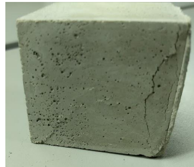
E. 90% de reemplazo de arena
