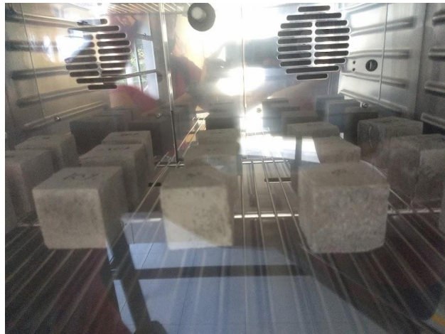
Imagen 21. Cubos retirados de la cámara a 20 °C y 90% de humedad
