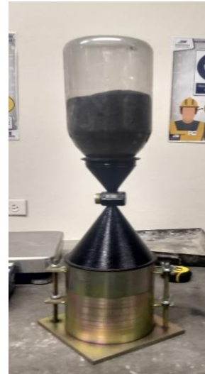
Imagen 6. Procedimiento para obtener densidad aparente de la calamina
