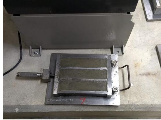
B. Mezcla con el 90% de reemplazo de calamina.
