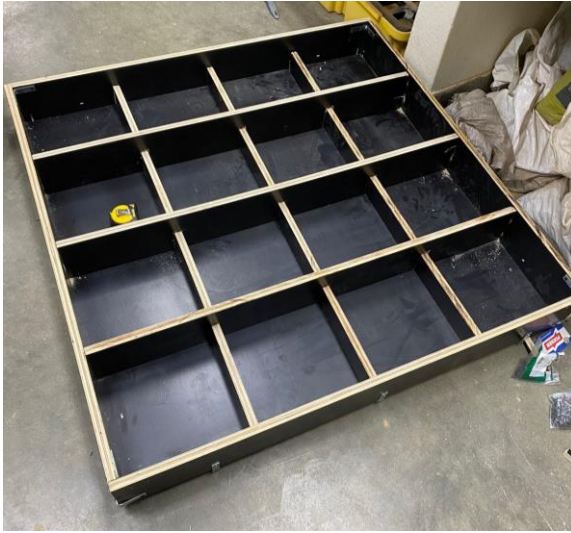
Imagen 30. Fabricación y vaciado de las baldosas
