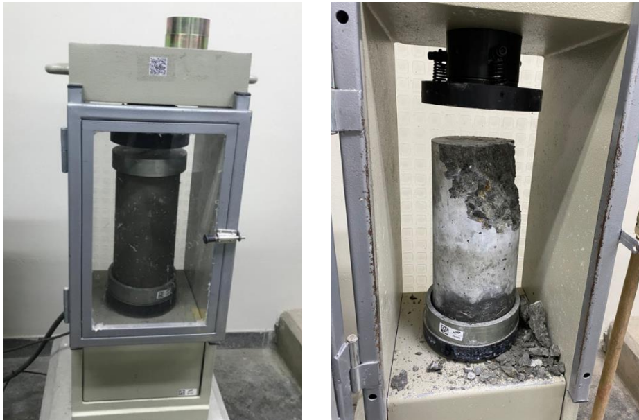
Imagen 13. Ensayo de resistencia a la compresión en cilindros
