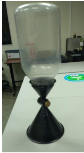
Imagen 6. Procedimiento para obtener densidad aparente de la calamina
