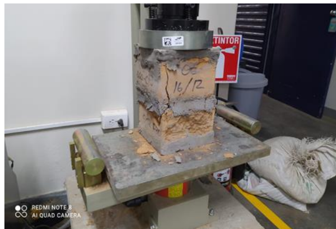
Imagen 40. Probeta fallada luego de la aplicación de la carga
