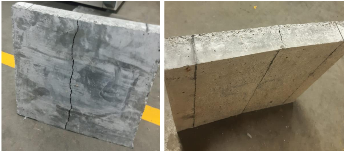
Imagen 32. Fracturas del ensayo de flexión
