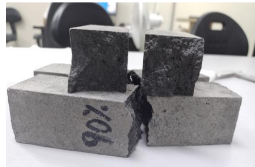
F. 90% de reemplazo de arena
