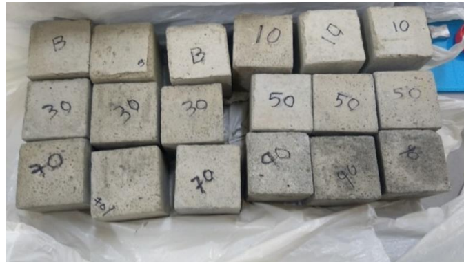
Imagen 18. Estado de cubos luego de 368 días a la intemperie
