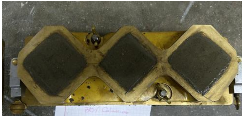
Imagen 14. Molde de muestra con reemplazo de 30% de arena por calamina
