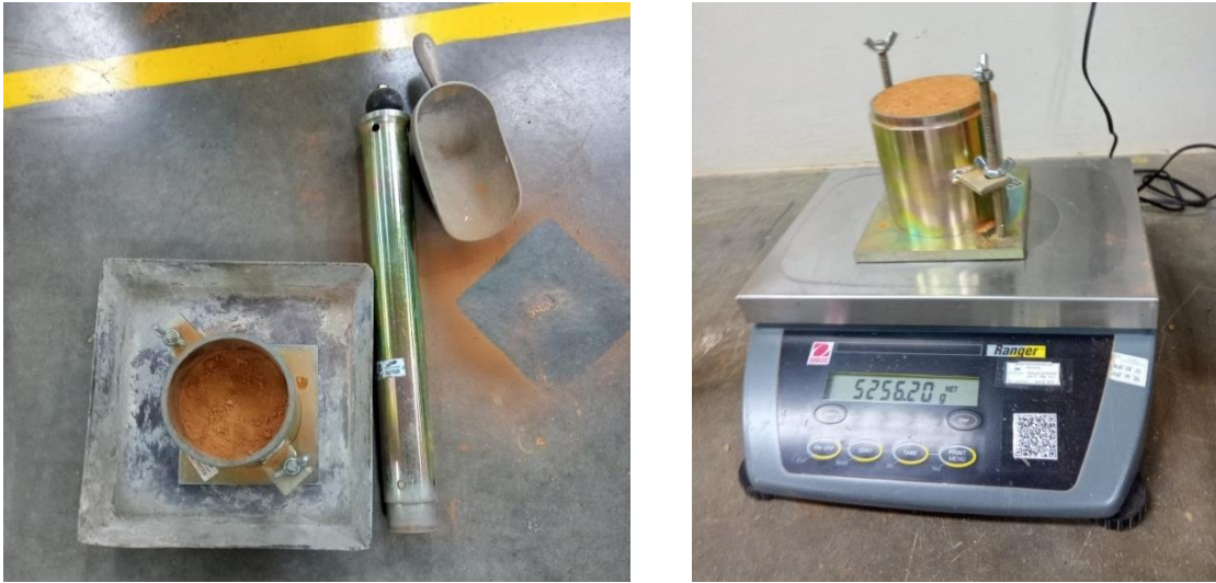
Imagen 36. Ensayo de Proctor Estándar para la mezcla.
