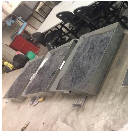
Imagen 9. Homogenización de la calamina para los ensayos en concretos
