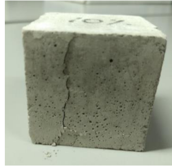
A. 10% de reemplazo de arena
