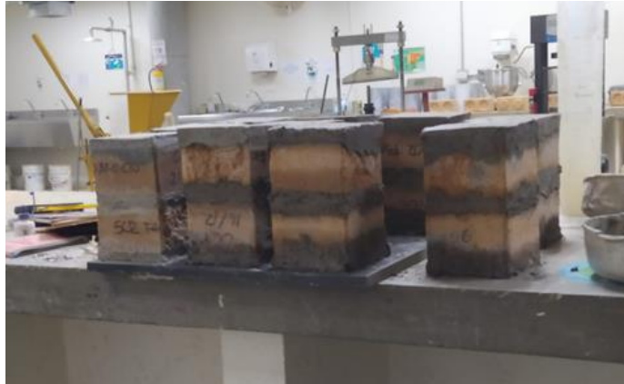
Imagen 40. Probeta fallada luego de la aplicación de la carga
