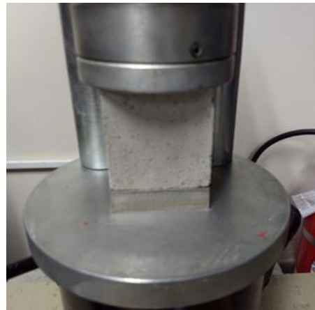
Imagen 19. Ensayo de resistencia a la compresión en cubos
