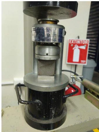
Imagen 19. Ensayo de resistencia a la compresión en cubos
