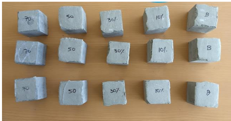
Imagen 23. Cubos retirados de la cámara a 35 °C y 60% humedad
