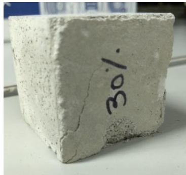
B. 30% de reemplazo de arena
