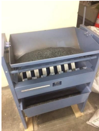
Imagen 9. Homogenización de la calamina para los ensayos en concretos
