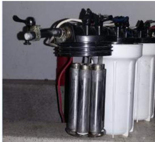
Figura 2. Dispositivo Generador de Oxihidrógeno. Fuente: elaboración propia.
