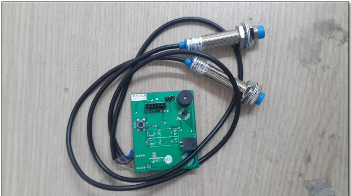
Figura N°15: sensor de registradora.
