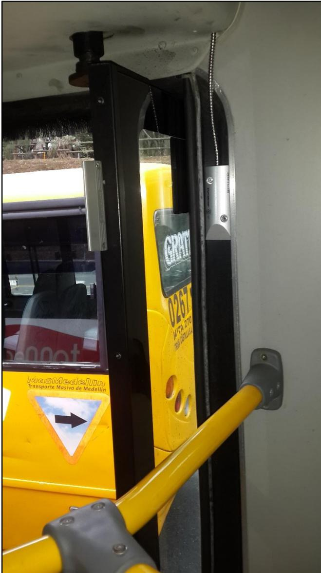
Figura N°14: sensor estado de puerta.
