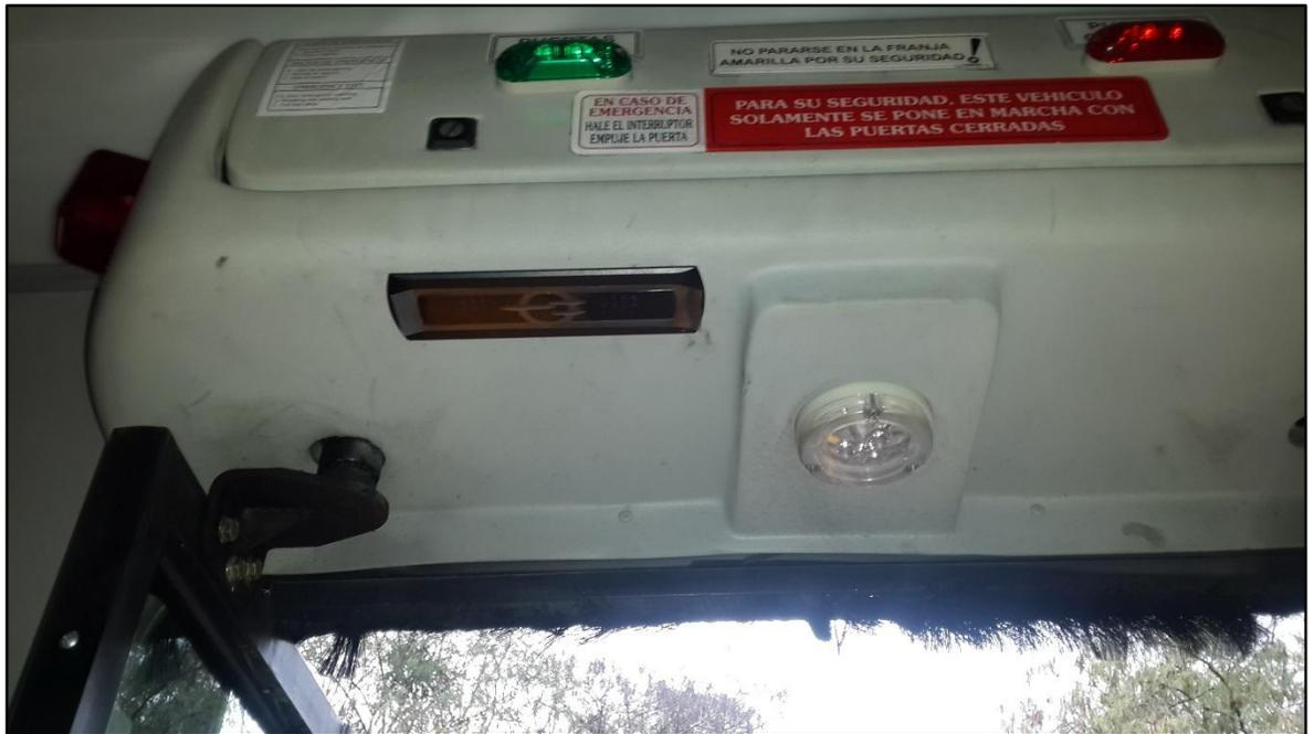
Figura N°13: sensor IRMA instalado en puerta trasera de vehículo.
