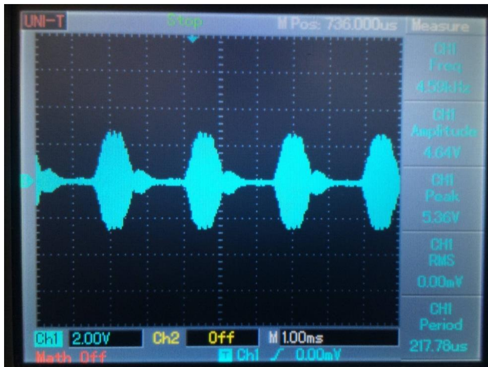
Figura 8. Salida etapa de amplificación
