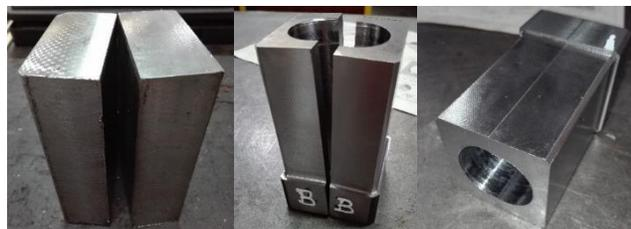
Figura 39. Fotografía tomada por el aprendiz del buje bipartido después de mecanizar, extraído de: Teléfono celular Huawei Ascend P7 (ver fig. 13).
