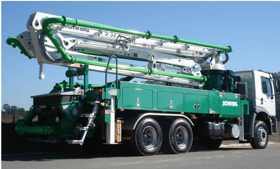
Figura 14. Autobomba de concreto (GENERAL EQUIPOS DE COLOMBIA, 2019)
