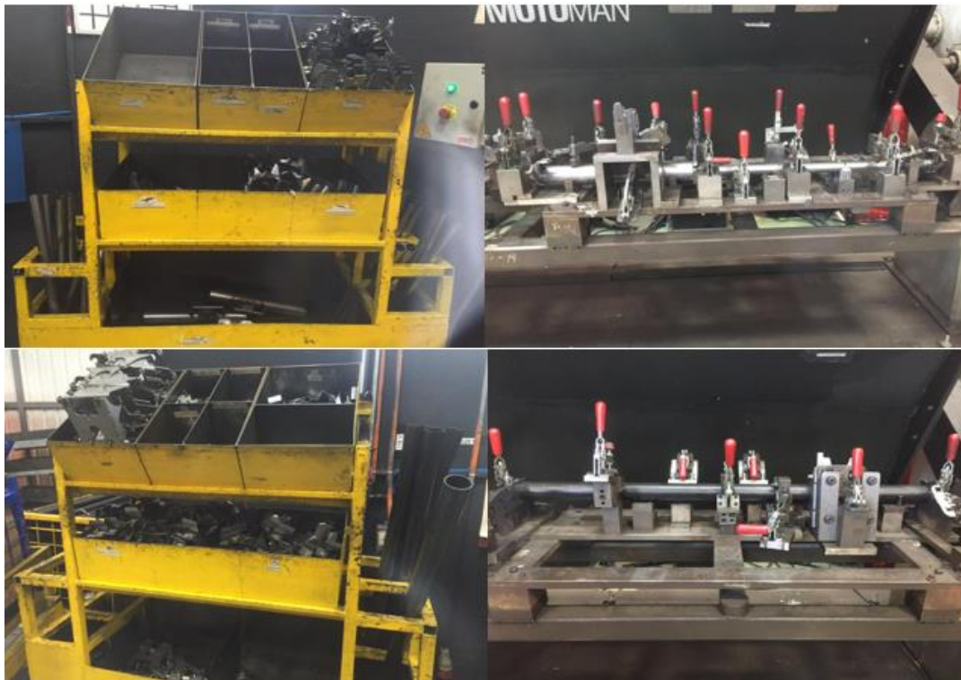
Figura 7. Ubicación de piezas en guías.
