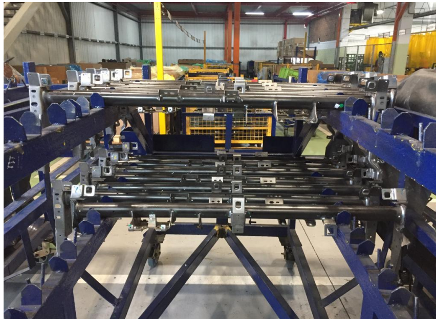
Figura 17. Traviesa final de H79 para ser llevada a línea de ensamble.
