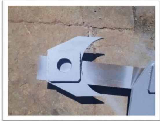
**Figura 29.** Construcción Platina Superior e Inferior (Autoría Propia)
