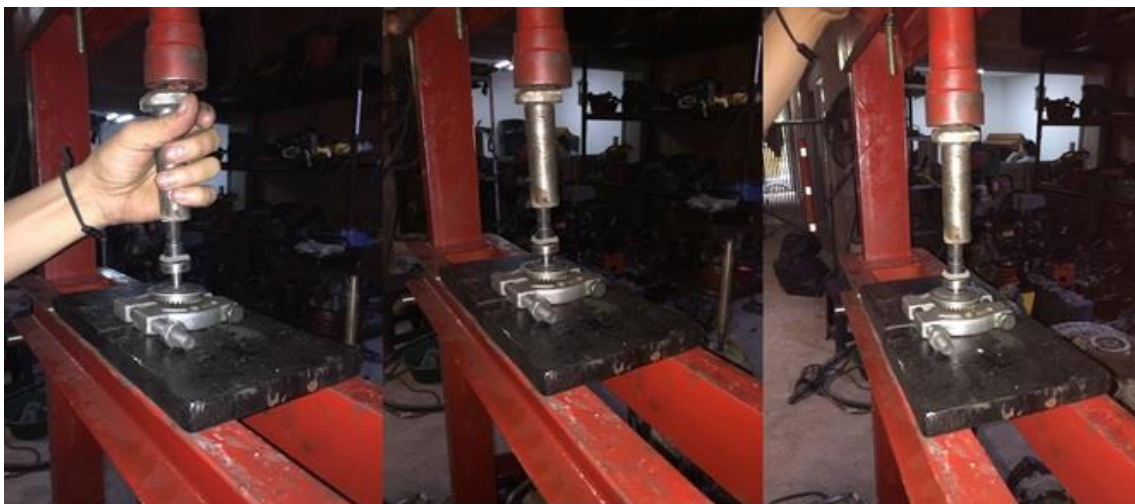
Figura 6. Inserción de rodamiento.
