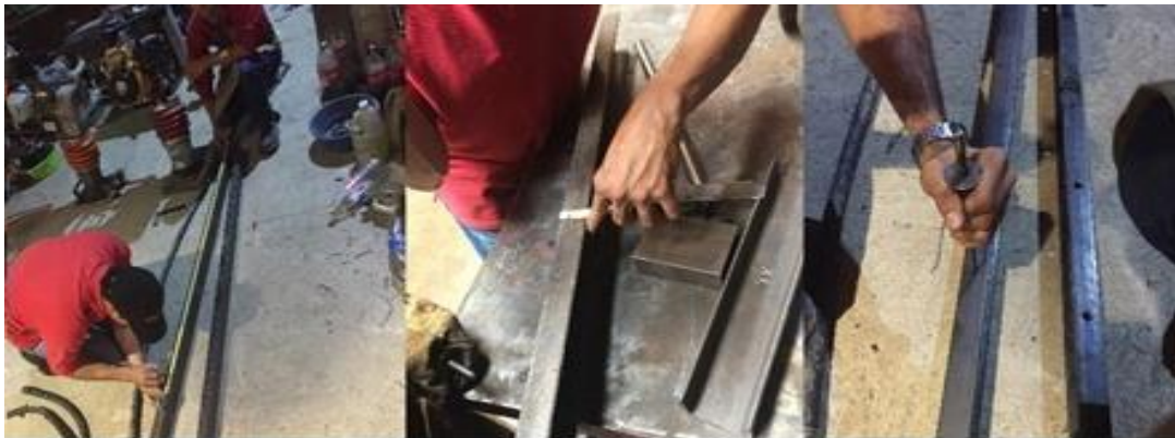
Figura 8. Toma de medidas y marcación de piezas.
