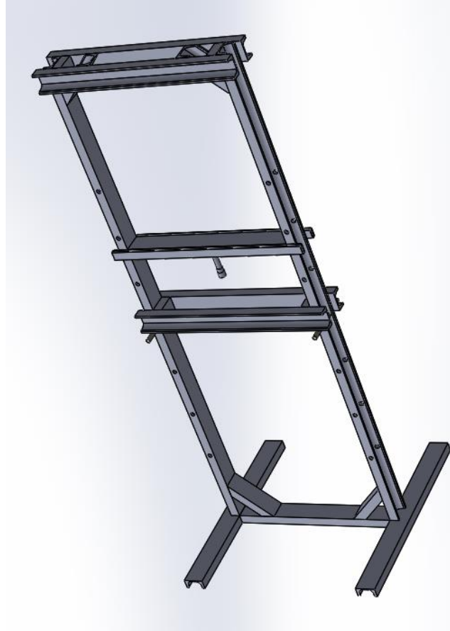
Figura 4. Prototipo estructura Prensa Hidráulica, Diseño realizado SOLIDWORKS® 2017.
