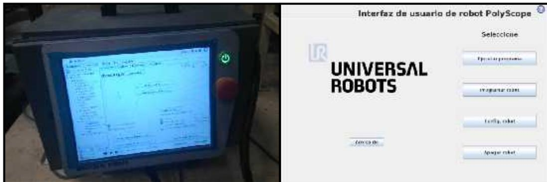
**Figura19.** Interfaz programación usuario-robot “PolyScope”.
