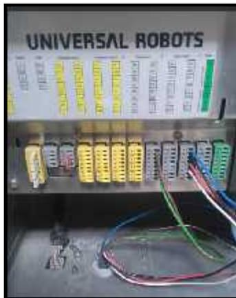
**Figura17.** Módulos de entrada y salidas PLC.
