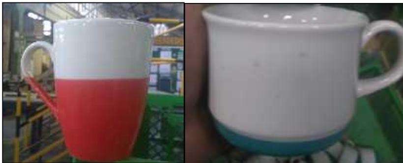
**Figura9.** Pocillos con defecto de desnivel.
