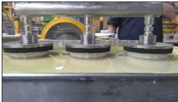
**Figura 11.** Primer Tridente para sujetar pocillos.
