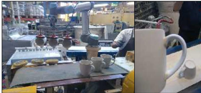
**Figura 23.** Dispositivo de sujeción para esmaltar la oreja del pocillo.
