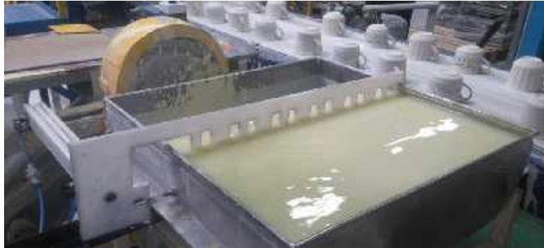
**Figura 20.** Tanque con mezclador para esmalte.
