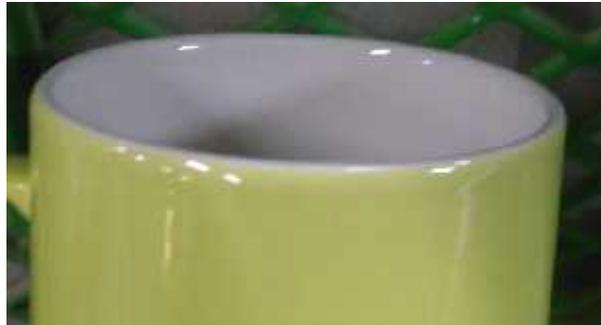
**Figura 29.** Esmaltado hasta el borde hecho por el robot.
