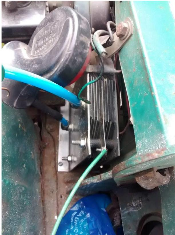
**Ilustración 9.** Instalación de la celda de combustible en el chasis del carro. Fuente: Elaboración propia
