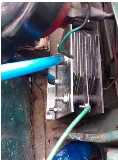
**Ilustración 14.** Celda de combustible fijada y funcionando. Fuente: Elaboración propia
