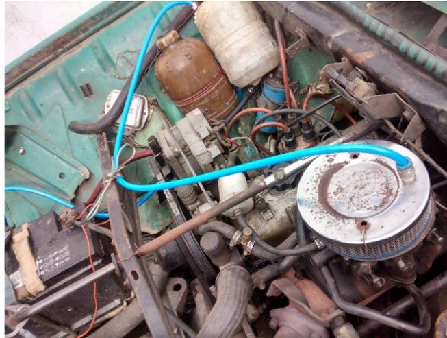
**Ilustración 10.** Perforación del filtro de aire para la adición de hidrógeno. Fuente: Elaboración propia
