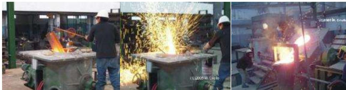
**Figura 22.** Horno de inducción (Isis Digital SCRL (W. Criollo), 2005)
