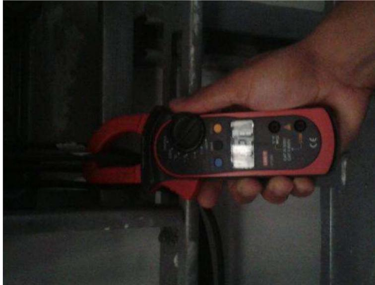
**Figura 28.** Mediciones de las líneas de alimentación que surten al compresor; L1, L2, L3. Fuente: Autores.
