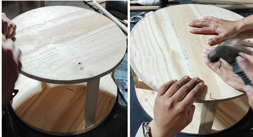
Pieza interna para el anclaje del eje giratorio para el círculo
