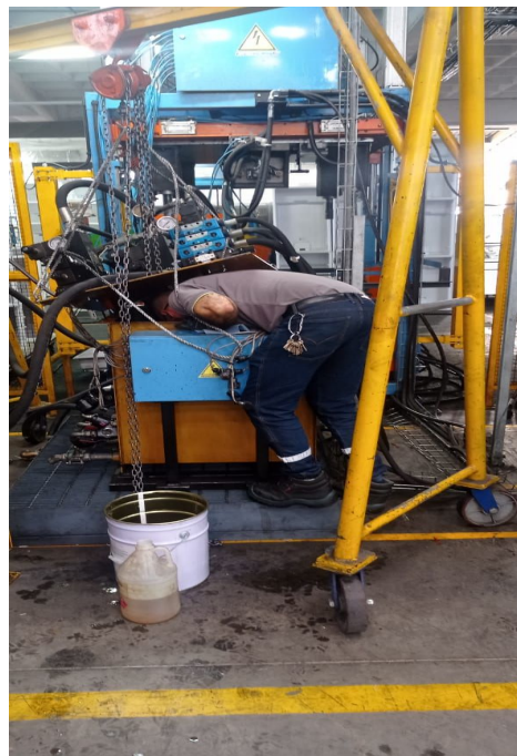
Ilustración 38. Unidad hidráulica troqueladora termo formado, intervención de tanque
