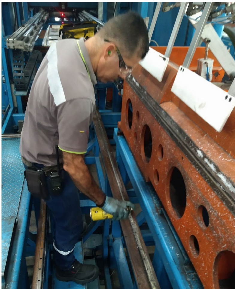
Ilustración 33. Gerardo lubricando guías zona de corte termo conformadora COMI
