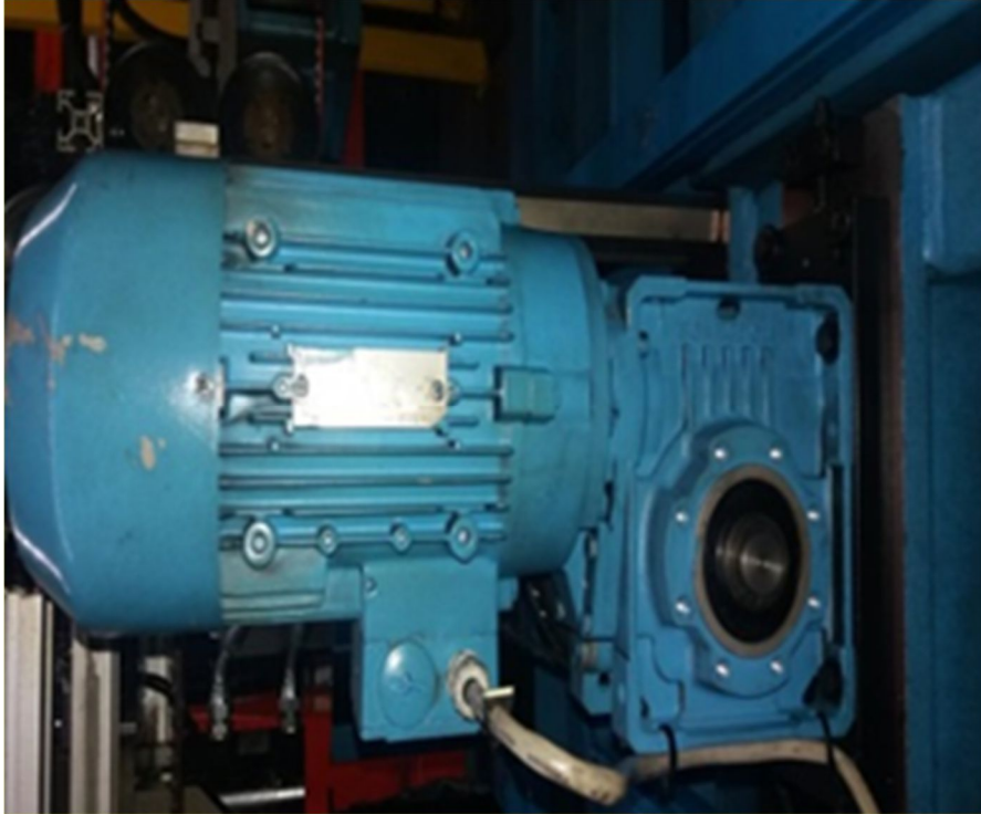
Ilustración 12. Reductor de banda de desplazamiento. Moto reductor utilizado para el transporte de lámina de una estación a otra.
