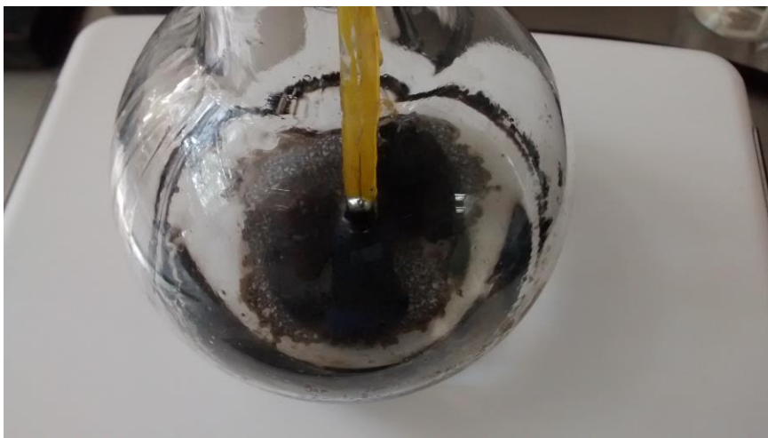
Figura 24: Imagen de magnetita estabilizada con ácido oleico inmediatamente después de haber terminado síntesis de co-precipitación.
