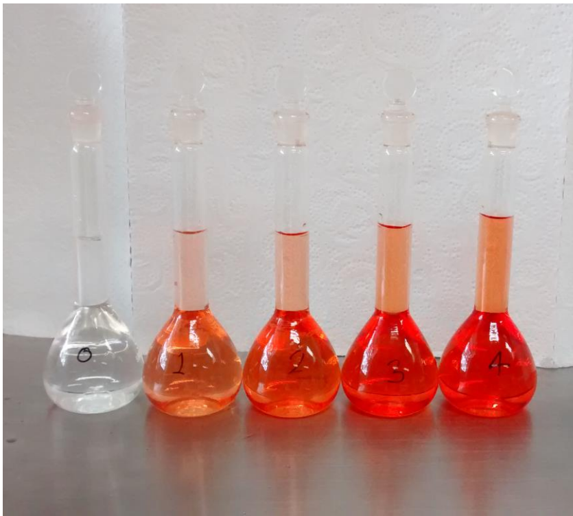
Figura 7. Soluciones estándar de hierro preparadas para la determinación de la pureza del Cloruro férrico comercial.
