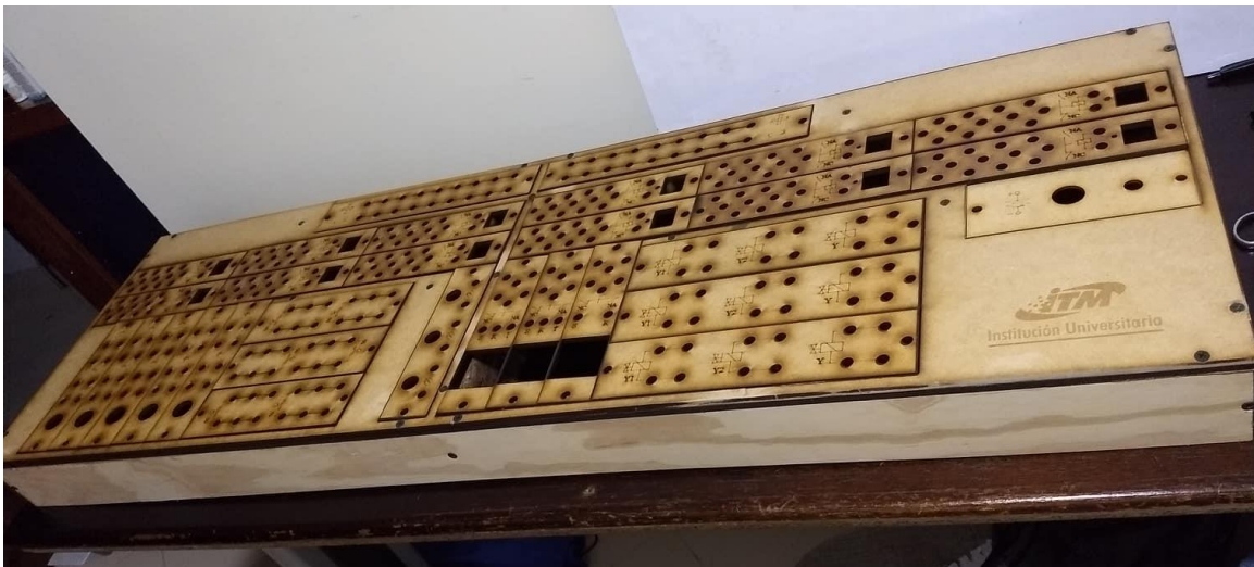
Figura 26. Ensamble de placas cortadas a la base previamente construida
