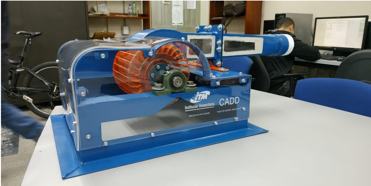
Figura 13. turbina tipo Michell-Banki terminada
