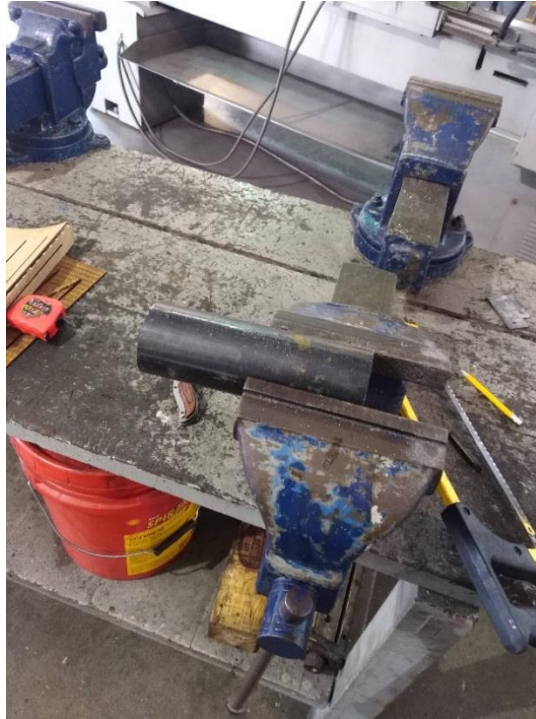
figura 5. corte manual de alabes usando segueta y prensa de tornillo
