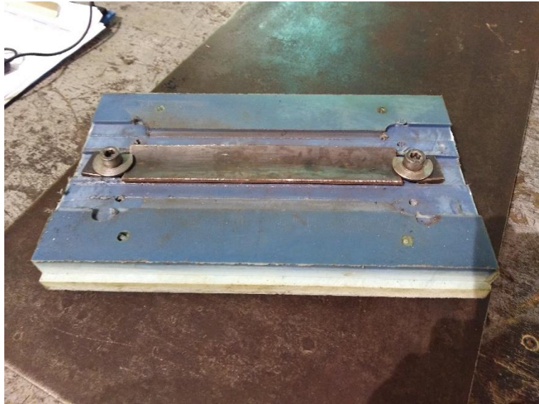
figura 6. Pieza de prolon usada para el montaje y ratificado de los alabes
