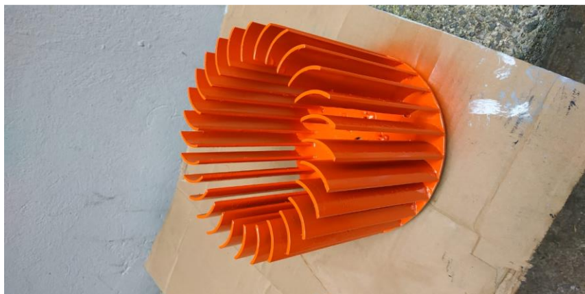
Figura 12. Rotor soldado a la parte del disco metálico y pintado
