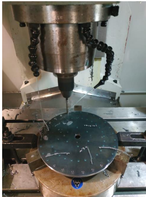
figura 9. Proceso de perforación en la platina con el torno CNC
