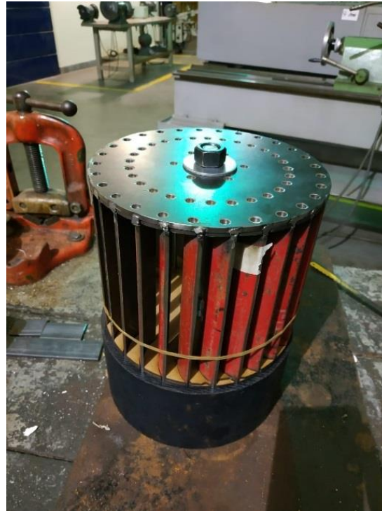
figura 11. Ensamblaje del rotor con sus discos de madera como formaletas para ser soldado
