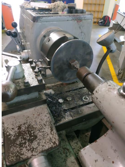
figura 7. Cilindrado de la platina en el torno convencional
