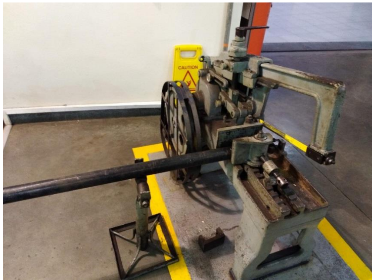
figura 4. máquina utilizada para los cortes de cada sección del tubo
