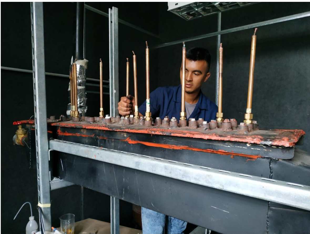
Figura 24 Instalación de los 10 termosifones cargados de agua desionizada
