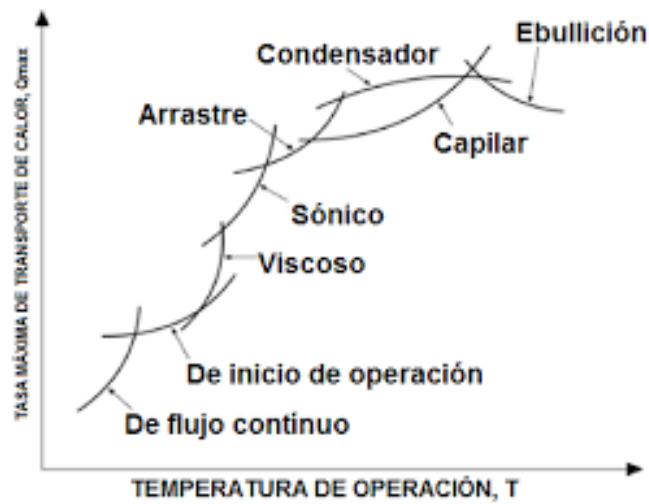
Figura 4 Límites de operación de un termosifón, (UNILA, n.d.)
