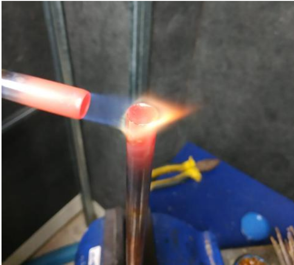
Figura 21 Proceso de soldado de las tapas de los termosifones
