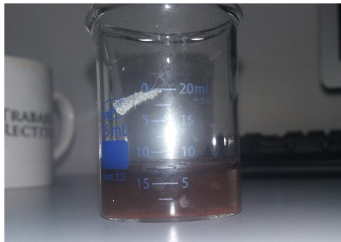
Figura 15 Volumen promedio del fluido encontrado en el interior de los termosifones
