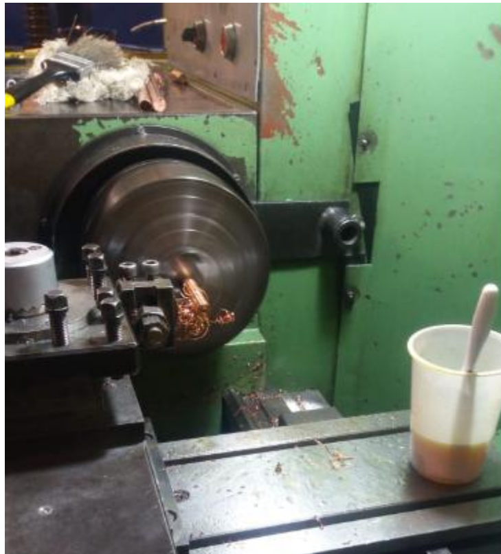
Figura 17 Mecanizado de las tapas para los termosifones
