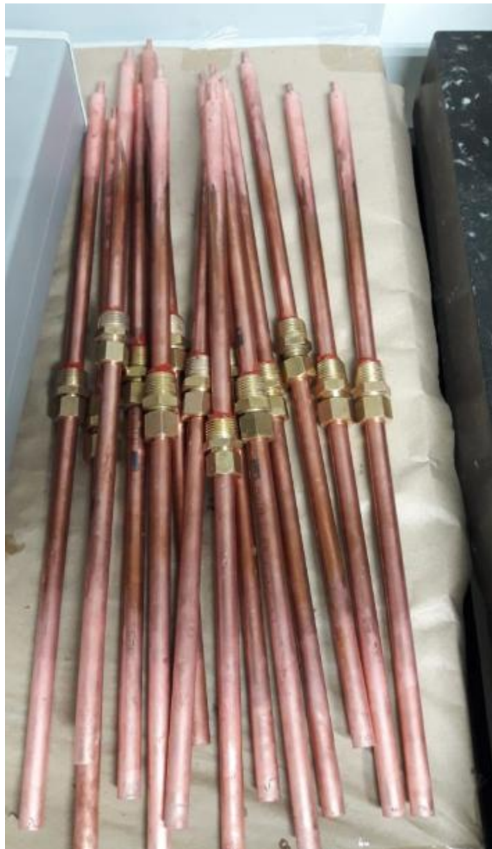
Figura 23 Termosifones completamente soldados
