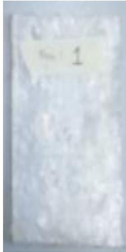
FIGURA. 32 Plancha #1 de polipropileno obtenida mediante moldeo por compresión
