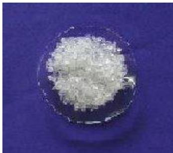
FIGURA .1 Polipropileno utilizado para mezclas
