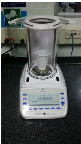
FIGURA. 8 pesaje polipropileno
