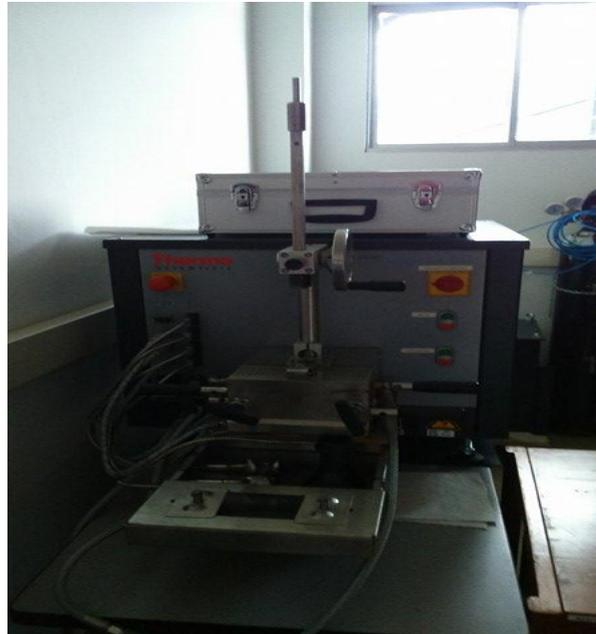
FIGURA. 5 Reómetro de torque Utilizado para realizar mezclas
