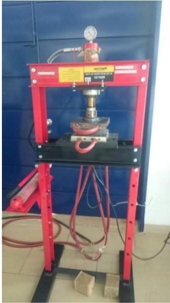
FIGURA. 27 Prensa hidráulica manual
