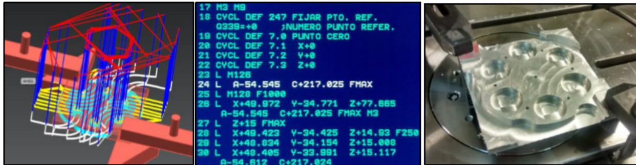
Figura 4. a) Programación CAM, b) Códigos Máquina y c) Fabricación final después de seguir los códigos de programación Fuente: elaboración propia
