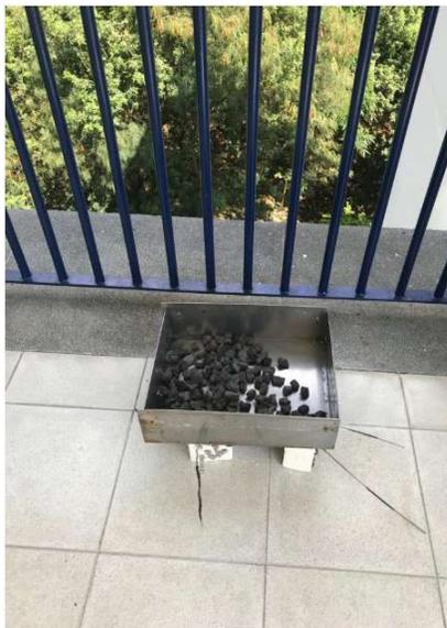
**Figura 20 Coque residual enfriándose, sobre ladrillo refractario**
