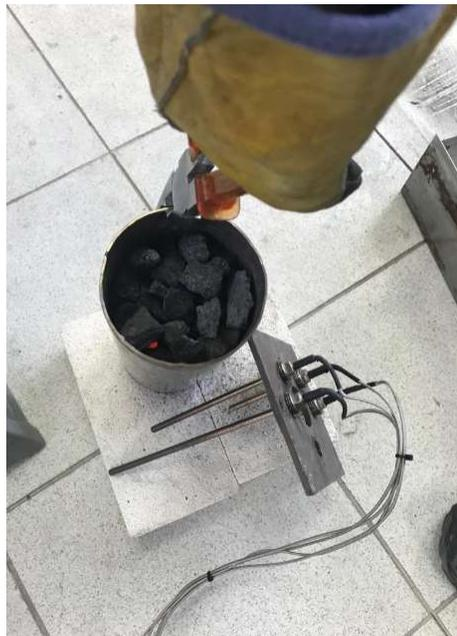
**Figura 19** Cilindro con coque caliente, listo para enfriarse.
