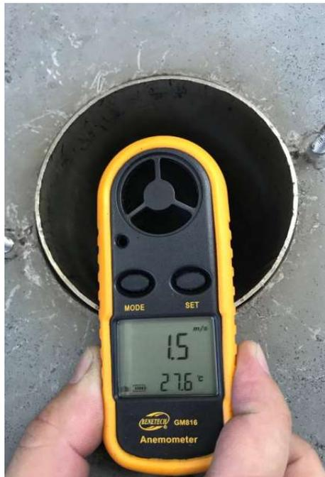
Figura 15 Proceso de calibración del flujo de aire a la entrada del recuperador, fuente propia
