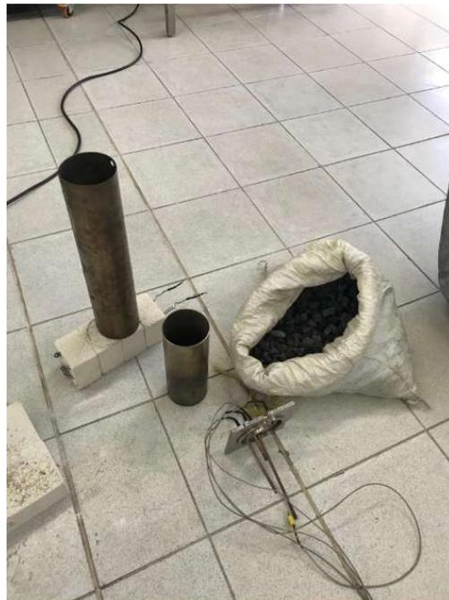
**Figura 11 coque, cilindros donde se deposita el coque y la tapa, con las termocuplas.**
