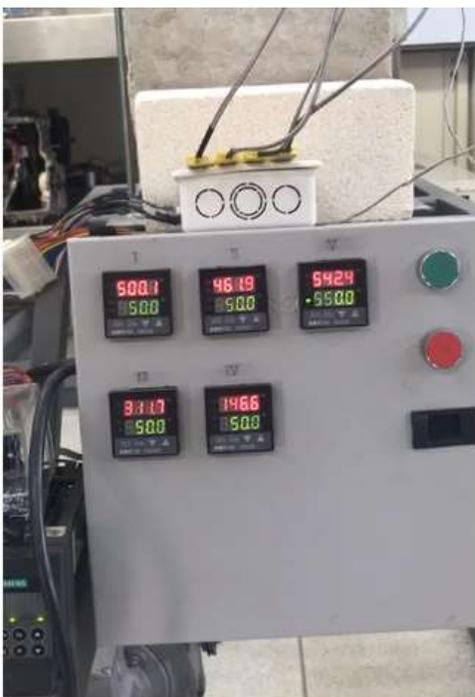
Figura 102 Sistema de medidores de temperatura, acoplados a las termocuplas, Fuente propia.
