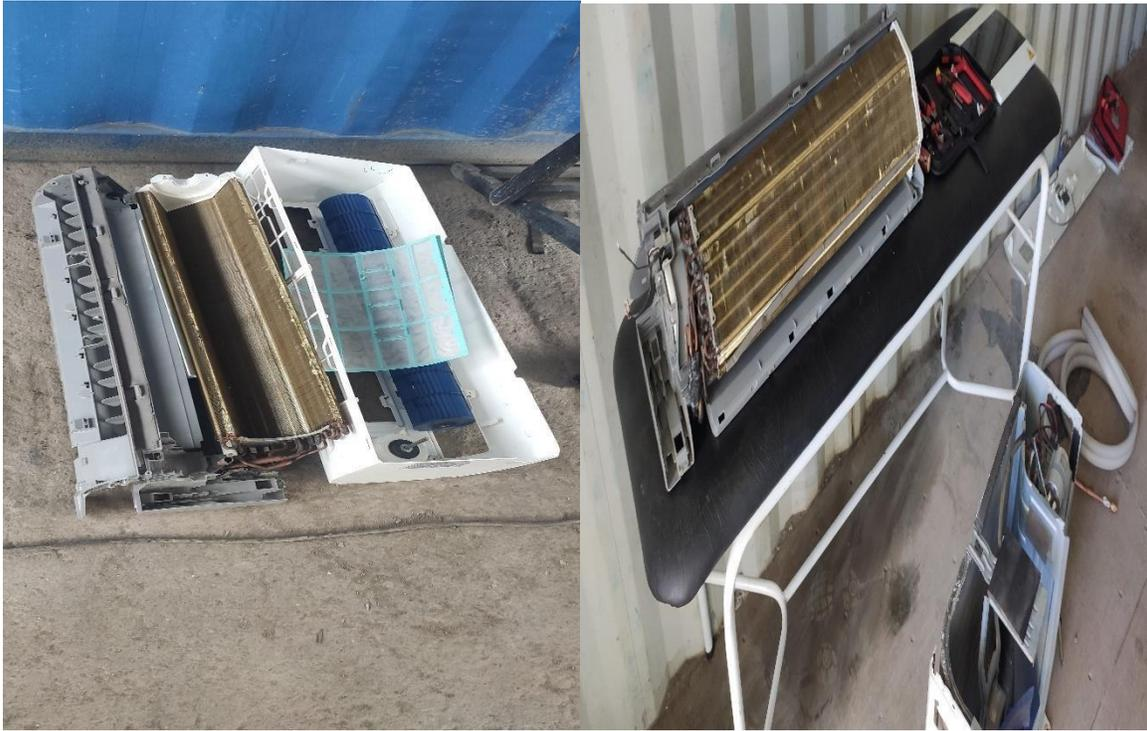
*Imagen 3 Unidad evaporadora de capacidad 12.000 Btu/h desarmada (FUENTE PROPIA)*
