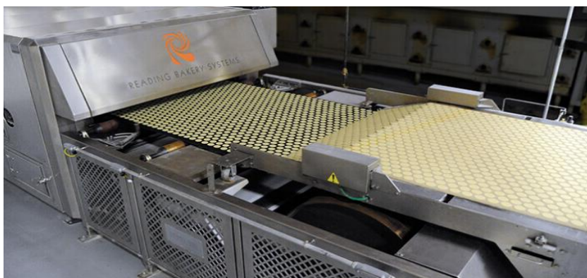
Figura 3 Modelo de horno Baker de convección directa utilizado en la fábrica de galletas Noel. Fuente Elaboración propia
