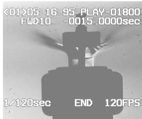
Figura 14 Ejemplo de ondas de choque en el deflector. (Carvajal M, 2019)
