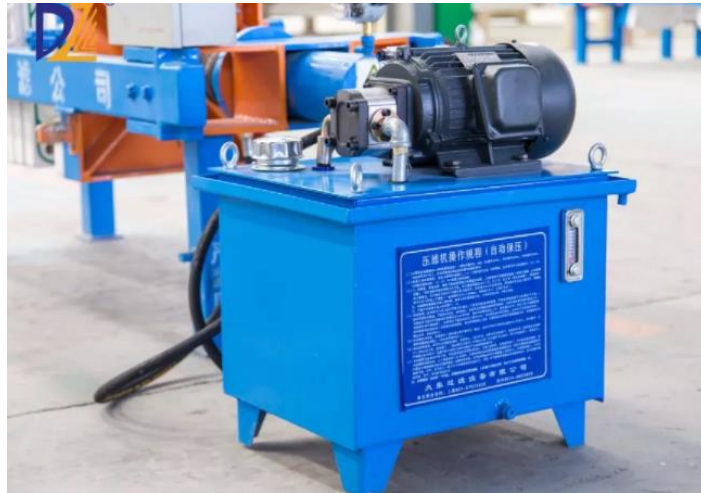
Imagen 14 tanque y bomba hidráulica
