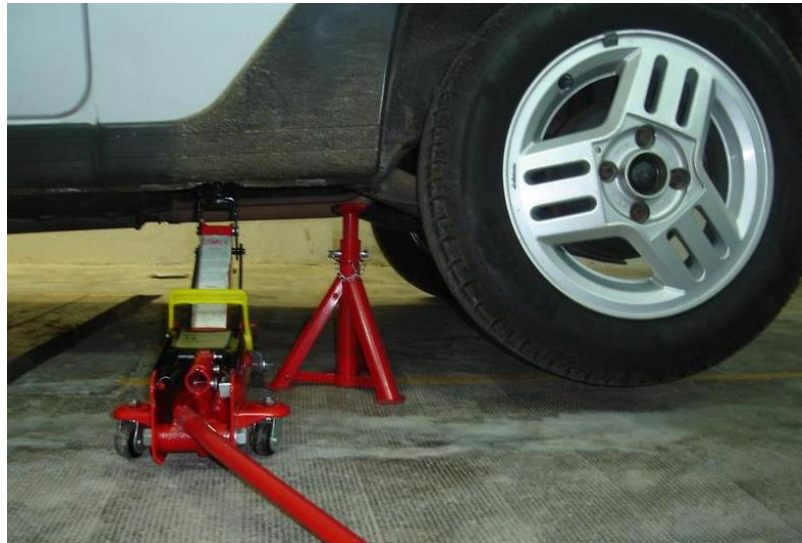
Imagen 11 Uso de gato y torre mecánica
