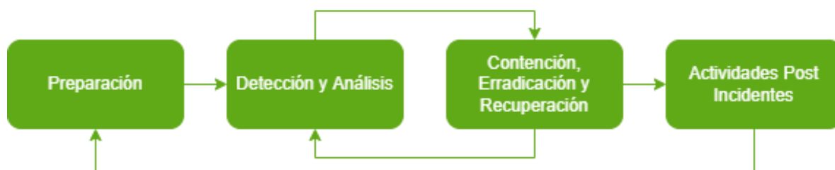
Figura 2 Fases ciclo de vida del modelo de gestión de incidentes NIST SP800-61
