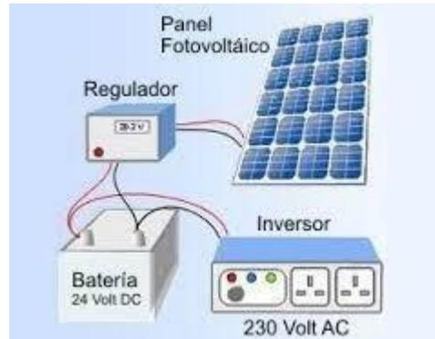
Figura 12. Regulador de instalación solar fotovoltaica.
