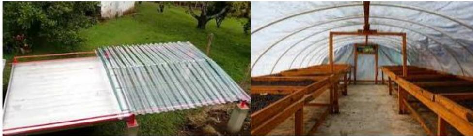
Figura 4. Secadores solares: a) Elbas con techo de zinc y b) Techo parabólico de plástico.
