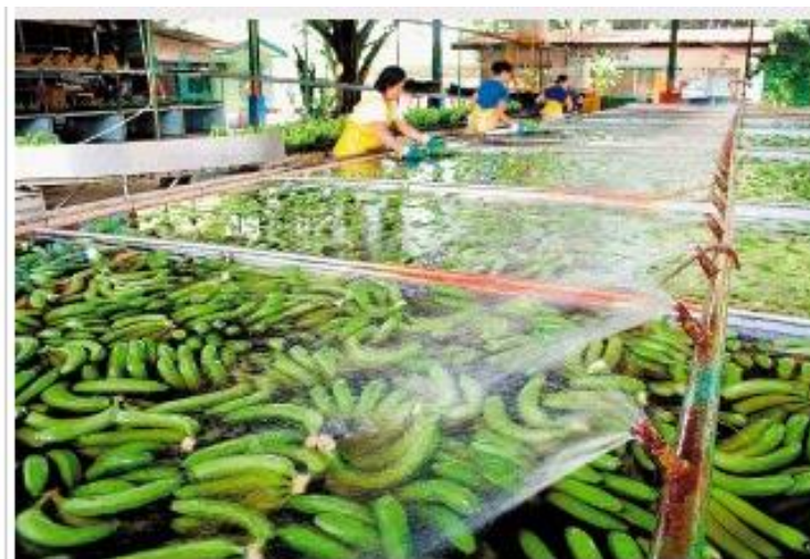
Figura 18. Tanque para desmane y gajeo; desleche y lavado. Fuente: (Barquero S., 2008)
