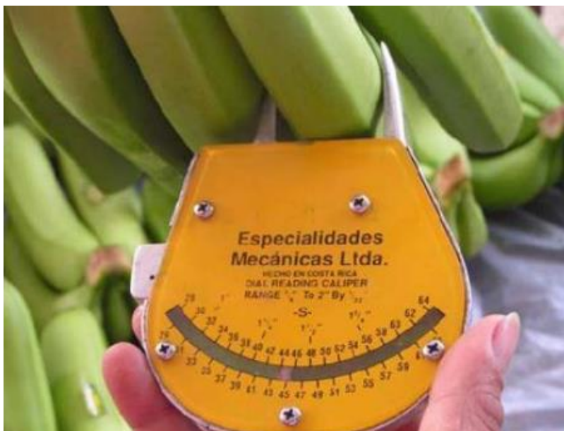
Figura 2. Calibrador estándar para medición de dedos de plátano. Fuente: (Rodríguez, Asistencia técnica dirigida en cosecha y post cosecha de banano organico, 2012)
