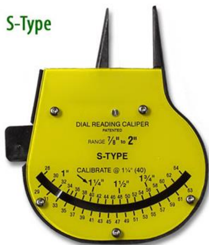
Figura 14. Calibrador análogo de plátanos. Fuente: (Oremor, 2007)
