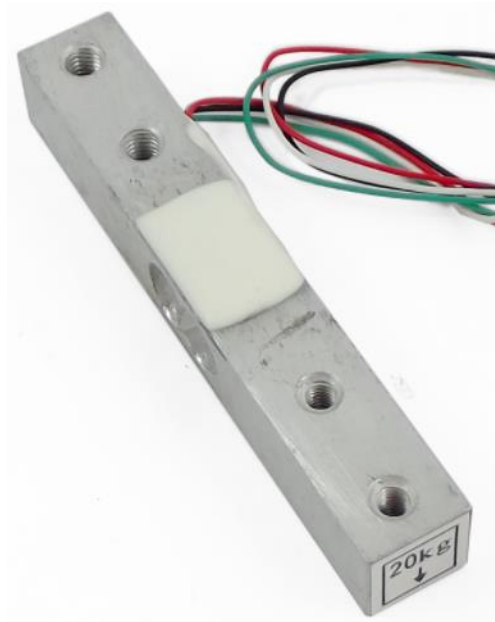
Figura 54. Celda de carga. (naylampmechatronics, 2019)
