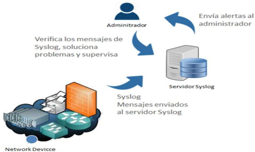
Ilustración 21. Funcionamiento de logs (Network Management Software, 2018)
