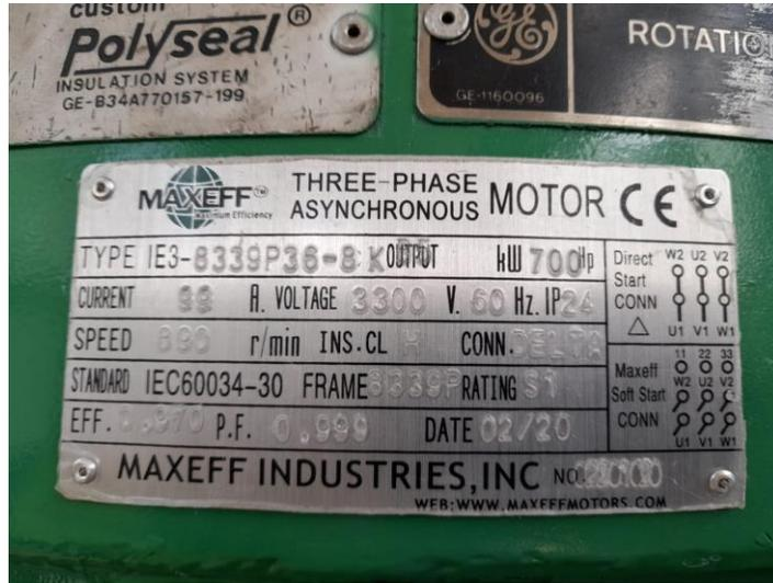
Figura 5. Motor convertido maxeff.
