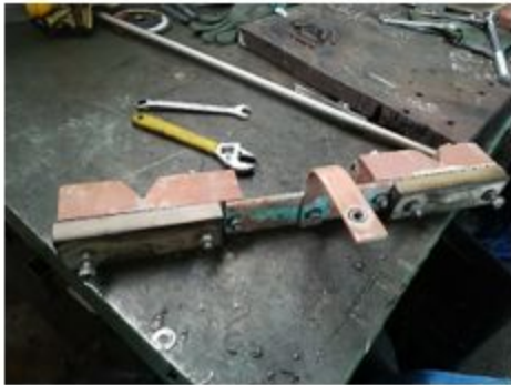
Desmontaje (Anodo-Catodo) Limpieza
