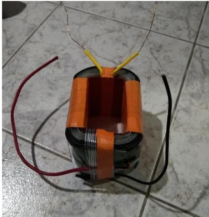
*Figura 3.* Bobinas del transformador finalizadas. Elaboración propia.
