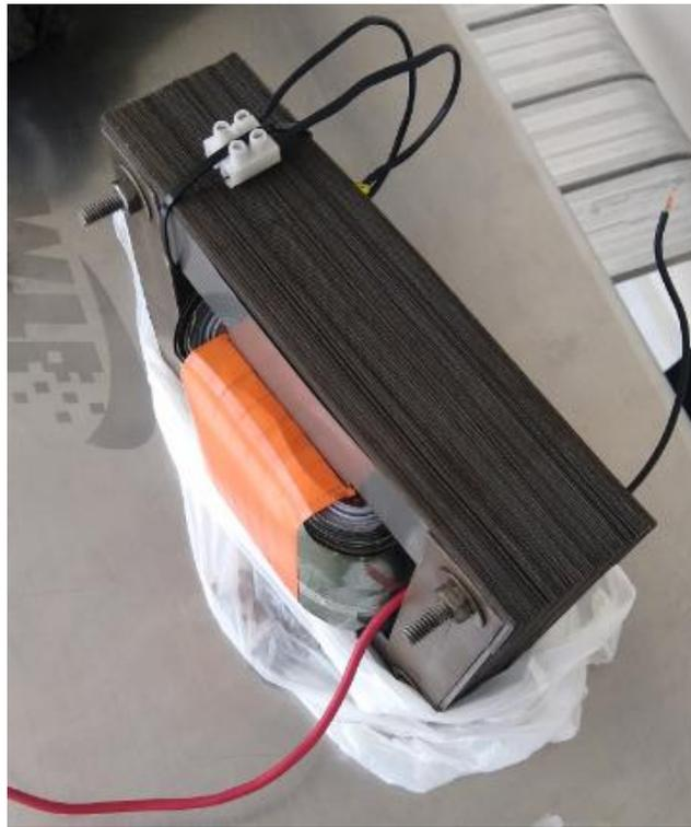
*Figura 4.* Transformador finalizado (núcleo y bobinados). Elaboración propia
