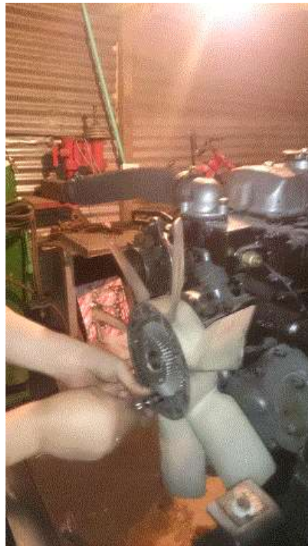
Figura 27. Proceso de ensamble del ventilador del motor (Autores, 2017).
