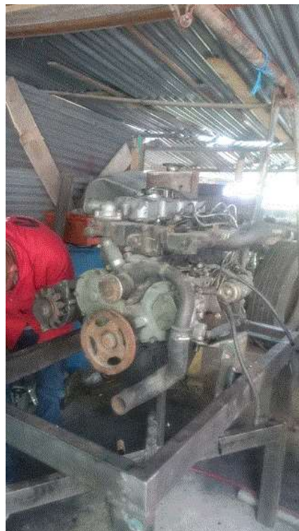
Figura 25. Proceso de reparación cambio de mangueras (Autores, 2017).
