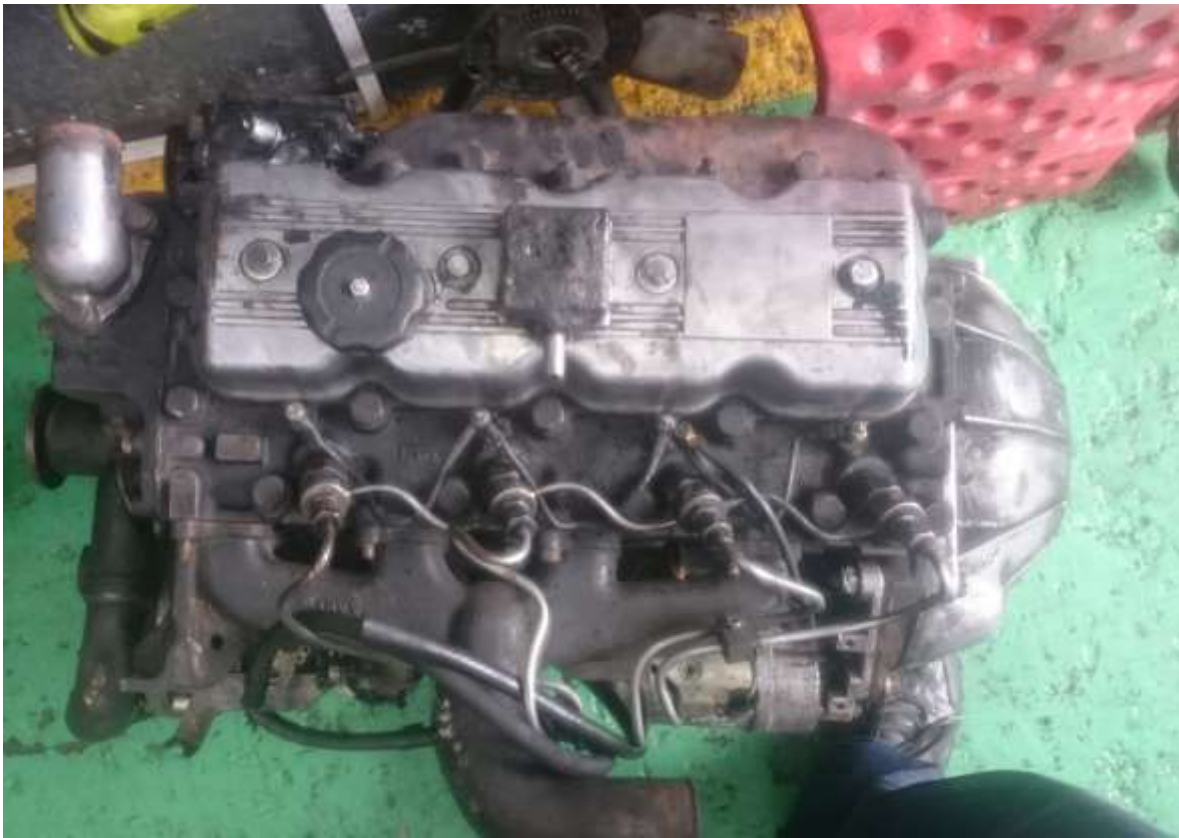
Figura 20. Vista superior del motor diesel (Autores, 2017).
