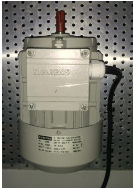
Figura 63. Motor trifásico Siemens de 0,4 HP.
