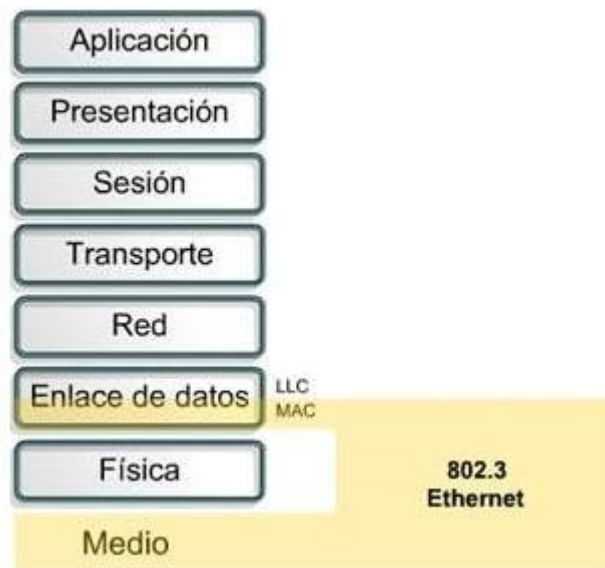
Figura 5. Ethernet en el modelo OSI.
