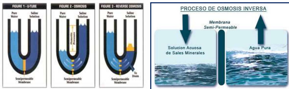
Figura 10. Proceso de Ósmosis Inversa (RO).
