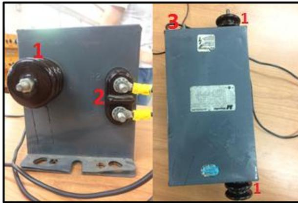
Figura 1. Transformador elevador utilizado. Fuente. Elaboración propia.
