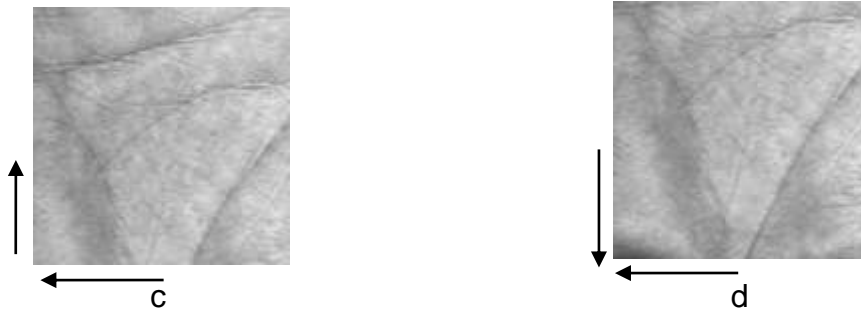
Figura 4. 14 Desplazamientos diagonales de la ROI. a) Desplazamiento en x de +13 y en y de +13. b) Desplazamiento en x de +5 y en y de -5. c) Desplazamiento en x de -14 y en y de -14. d) Desplazamiento en x de -16 y en y de +16.
