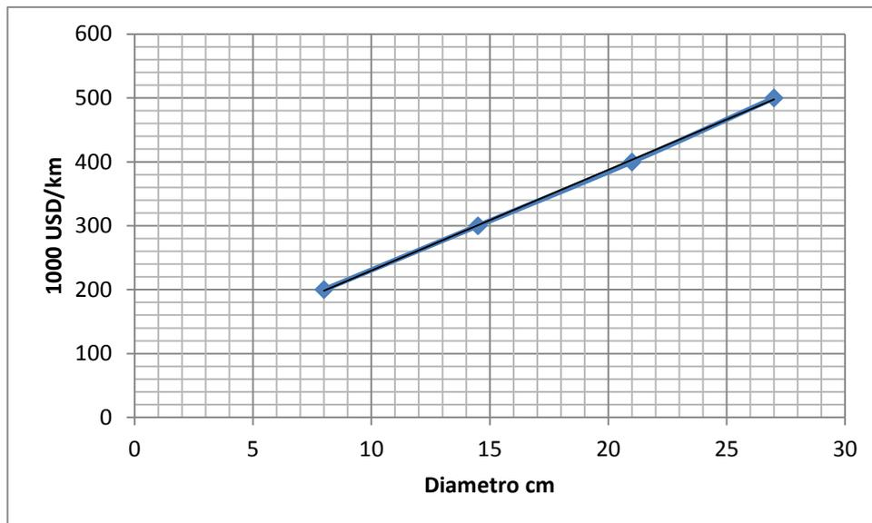
**Figura 17. Costo de la tubería para transportar hidrógeno en función del diámetro.**
