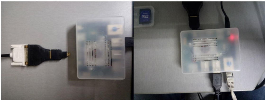
Fig 11. Disposición de adaptadores para conexión del puerto dedicado a la imagen. (Izquierda)
