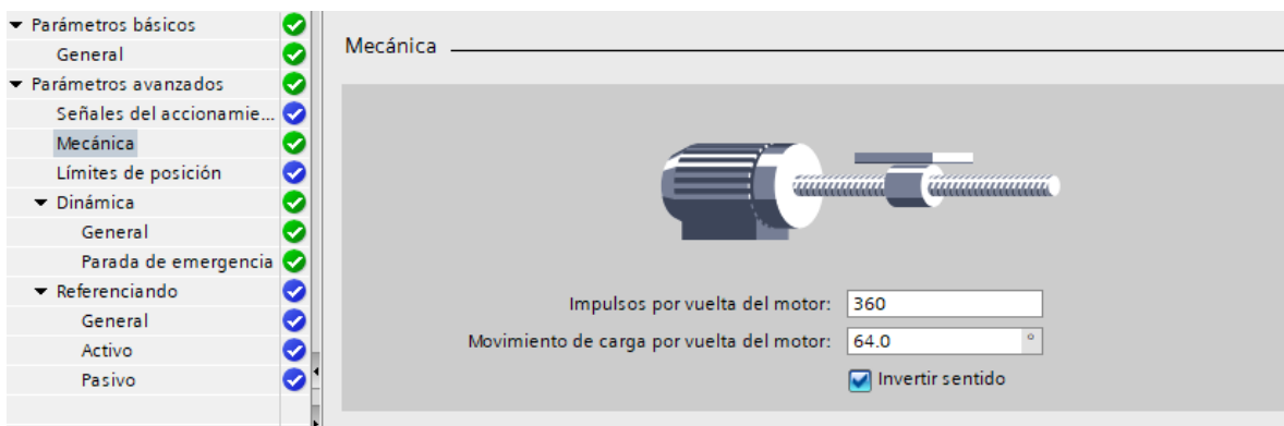
Figura 4. Variable mecánica del motor
