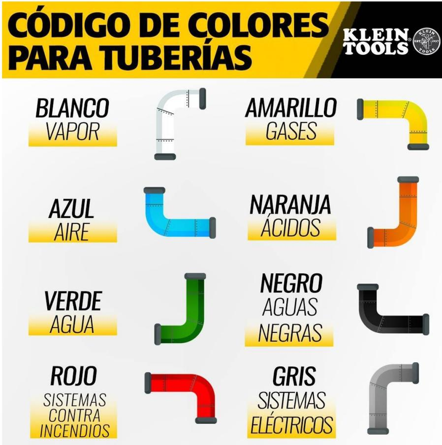
Ilustración 7. Código de colores para tuberías Klein Tools (2023). Código de colores para tuberías.
