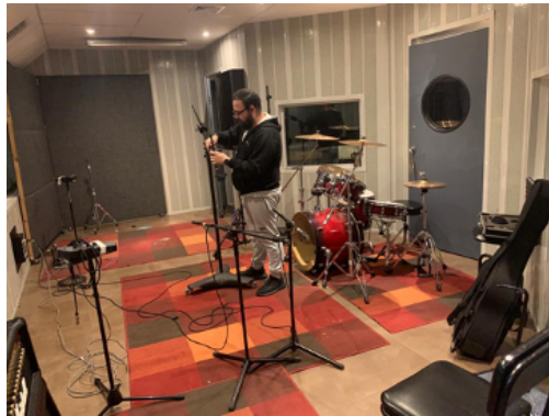
Figura 46. Conexión de los micrófonos Neumann KM 184 en el estudio del ITM sede La Floresta
