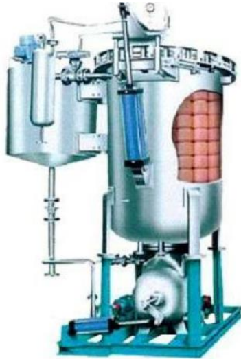
Figura 4: Autoclave vertical para teñido de hilos en bobinas.
