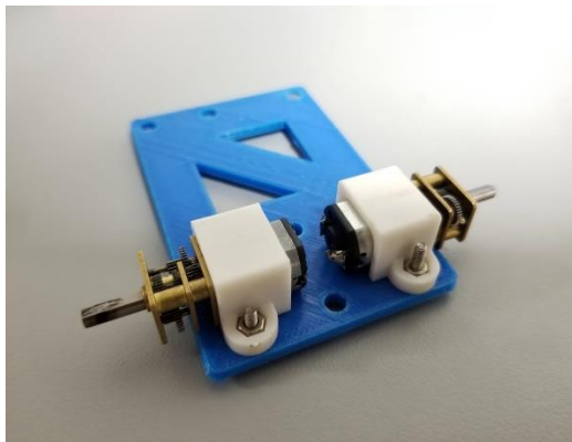
Figura 5. Motorreductores acoplados a base
