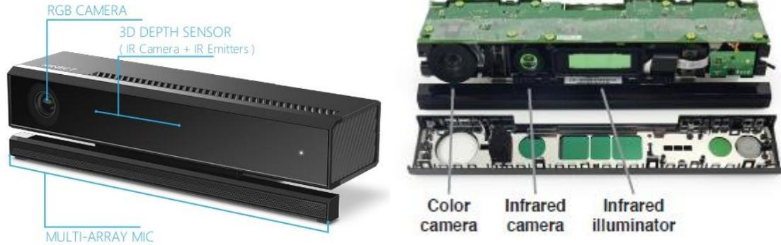
Figura 1 Diseño del Kinect V2 y ubicación de las cámaras y sensores. (Tomado de (Bloesch et al., 2015)).
