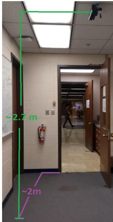
*Figura 9 Montaje del Kinect*
