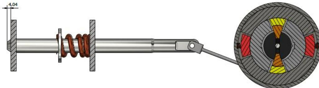
*Figura 51. Activación y sincronización del sistema de seguridad.*
