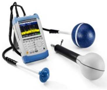
Figura 8. Antena Isotrópica TSEMFB1 101732 y analizador de espectro R&S FSH 8 (ROHDE&SCHWARZ, 2015)
