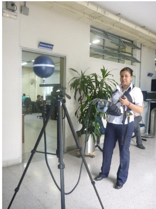
Figura 9. Ubicación central antena y montaje
