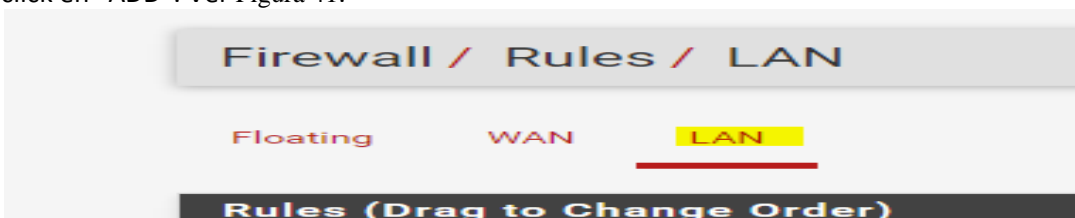
Figura 41. Interfaz de red a la que se le aplica la regla. Fuente: Pfsense
