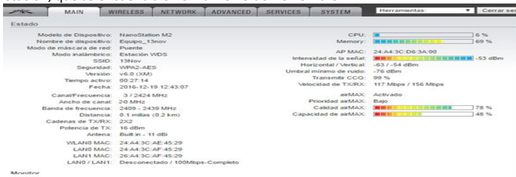
Figura 73. Pestaña de Configuración Main del Equipo Estación. Fuente: NanoStation M2. 2016.
