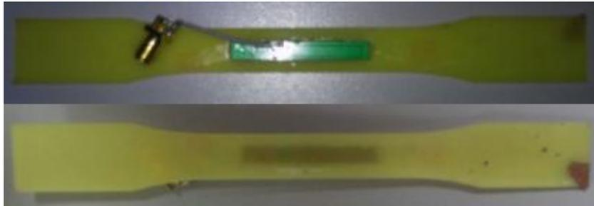
Figura 6. Antena GSM por ambas caras, con su respectivo conector SMA para la conexión al analizador vectorial de redes soportada sobre una base tipo probeta, para facilitar su deformación.
