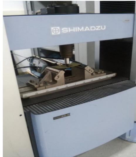
**(b).Antena patch con CSRR sometida a deformación en la máquina de tracción.**
