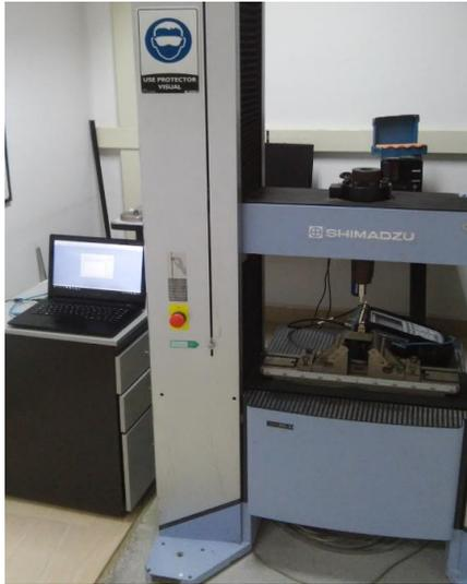
**(a).Antena meanderline sometida a deformación en la máquina de tracción.**
